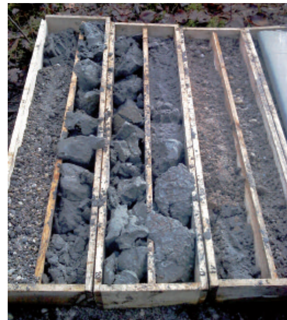
Abb. 3 Schichtenaufbau der Sondierungsbohrungen (toniger Zwischenhorizont)
